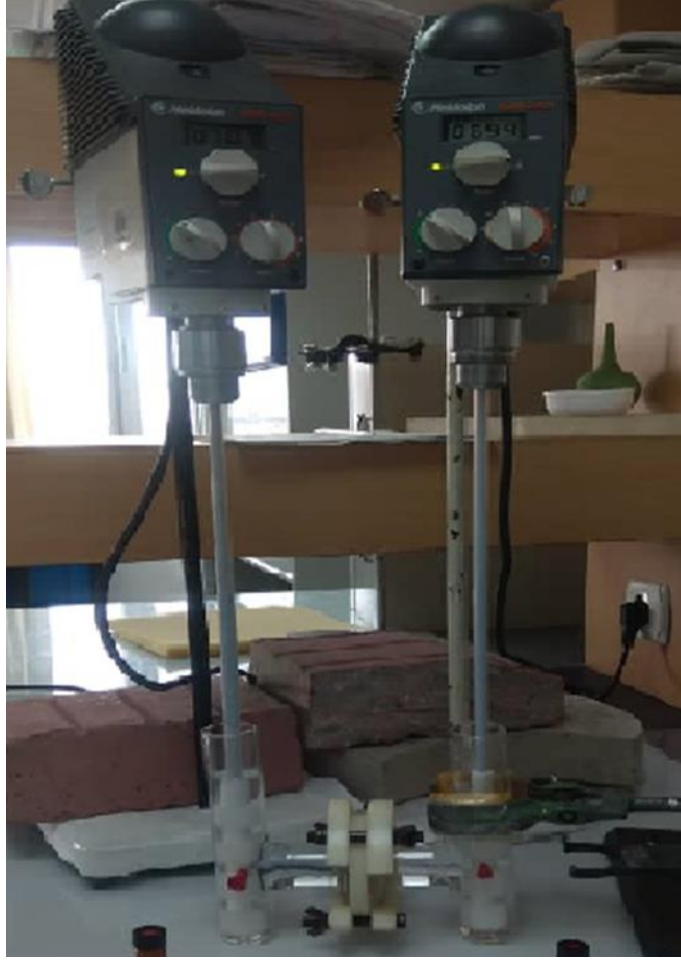
Şekil 3.4. Polimer içerikli membrana ait test hücresinin şematik olarak gösterilmesi
