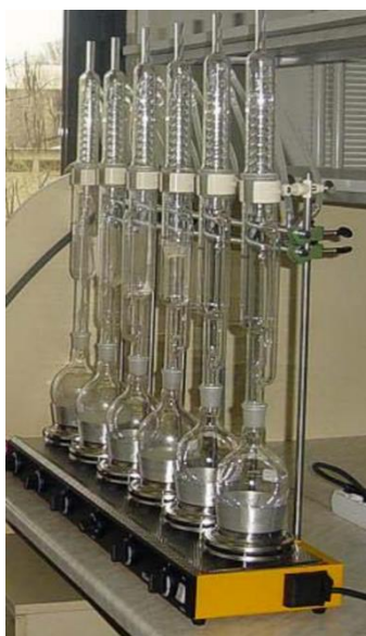
Сүрөт 2-3. Соклет экстракциялоочу орнотмосу.
