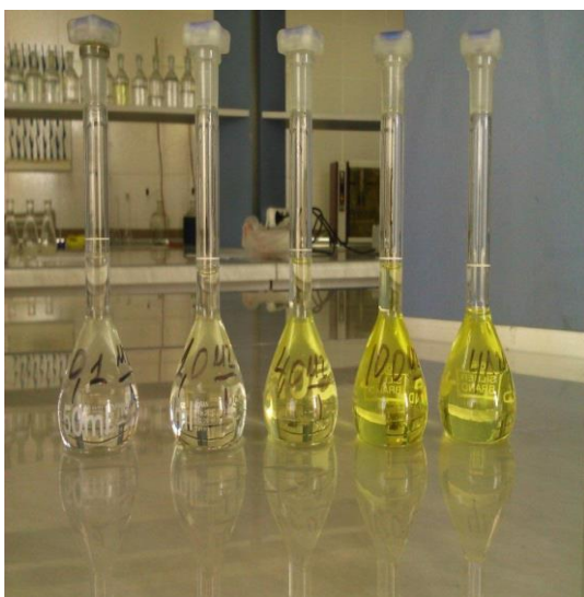
Сүрөт 2.1.3 Үлгүлөрдү спектрофотометрде окуутуга даярдоо
