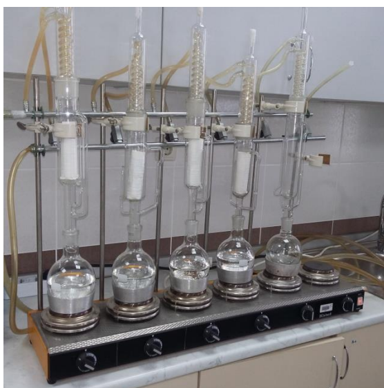
Сүрөт 8. Изилдөөдө колдонулган Сокслет аппараты
