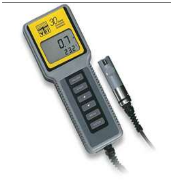
Сүрөт 2-14 «YSI Model 30» электр өткөрүмдүүлүк ченөөчү аппараты.
