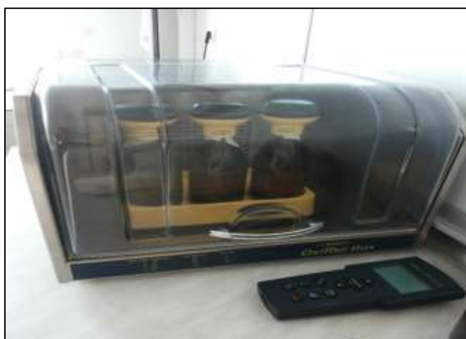
Сүрөт 2-27 Суунун биологиялык кычкылтекке муктаждыгын ОХИТОР жабдыгы менен аныктоо учурунда
