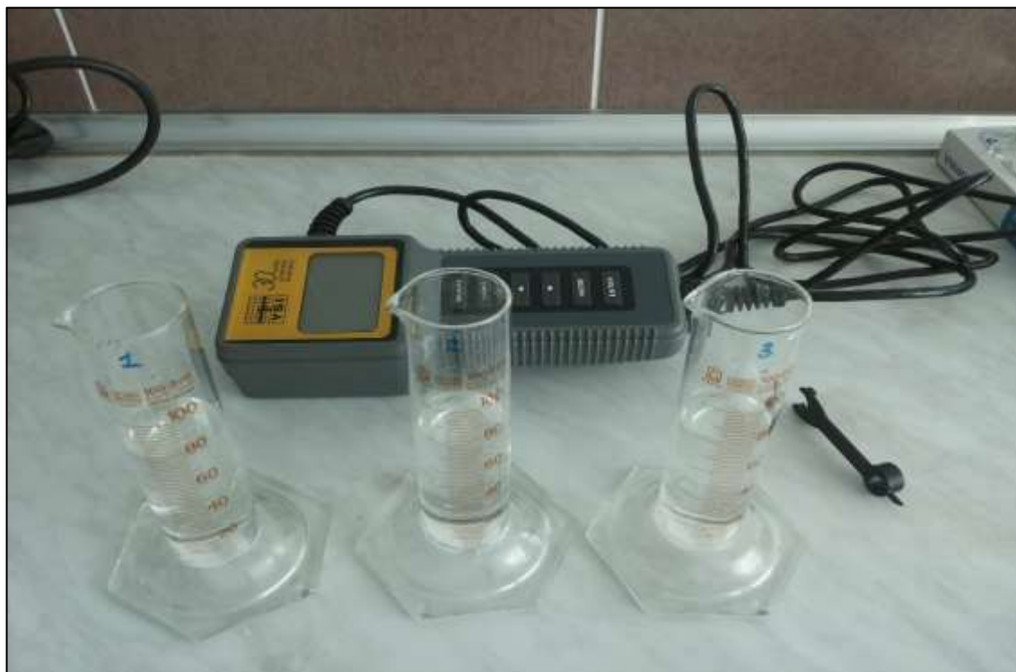
Сүрөт 2-20 « YSI Model 30 » электр өткөрүмдүүлүк ченөөчү аппаратынын жардамы менен суу үлгүлөрүн электр өткөрүмдүүлүгүн ченөө
