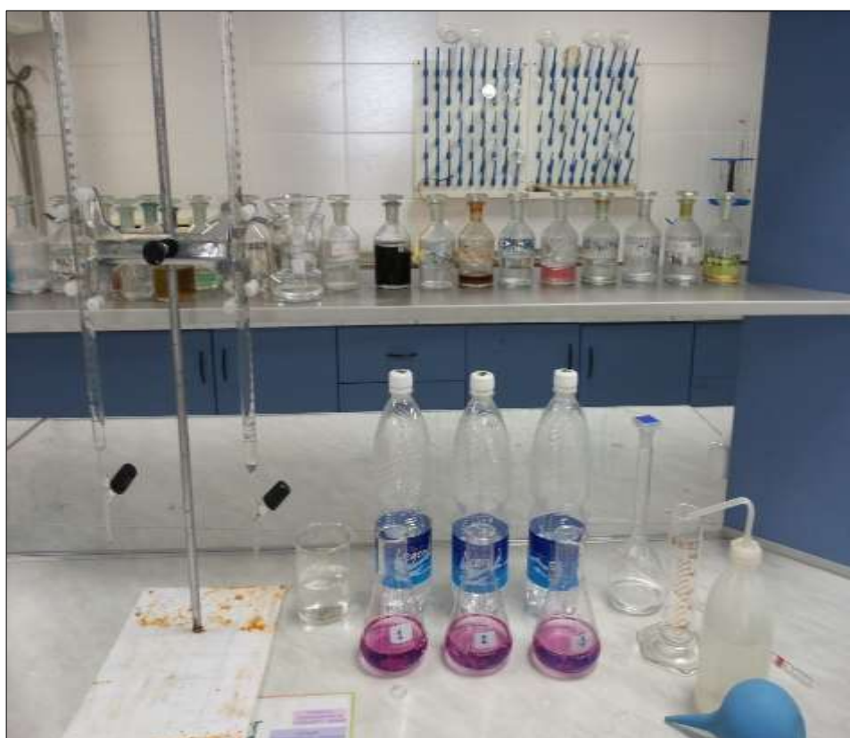
Сүрөт 2-8 Комплексонометрикалык титирлөө
