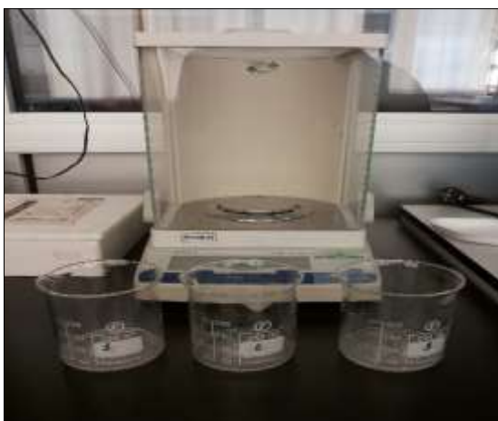
Сүрөт 2-7 Стакандардын массасын аналитикалык таразада тартуу.
