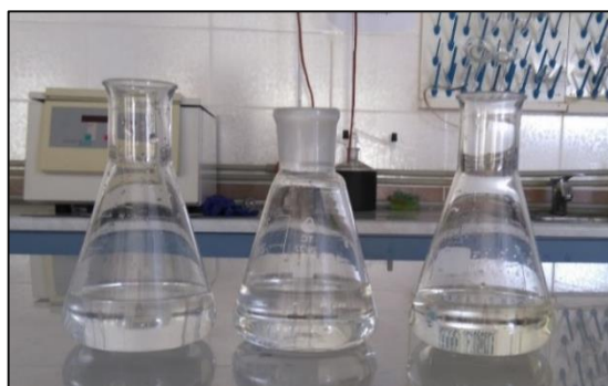
Сүрөт 2.1.8. Натрий тиосульфат менен түссүздөнгө чейин титрлөө
