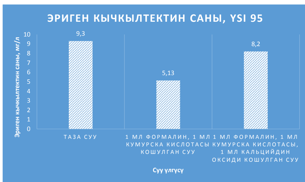
Сүрөт 2.1.1.2. YSI 95 аппараты менен ченелген эриген кычкылтектин саны
