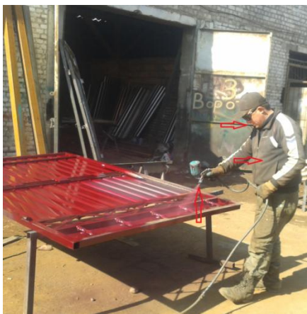
1 сүрөт. Сырдоо иштери жалпы талапка жооп бербеген учурдагы иш алып баруу
